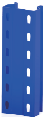
Post : 100*67 Pitch : 50mm Hole : Waterdrop
